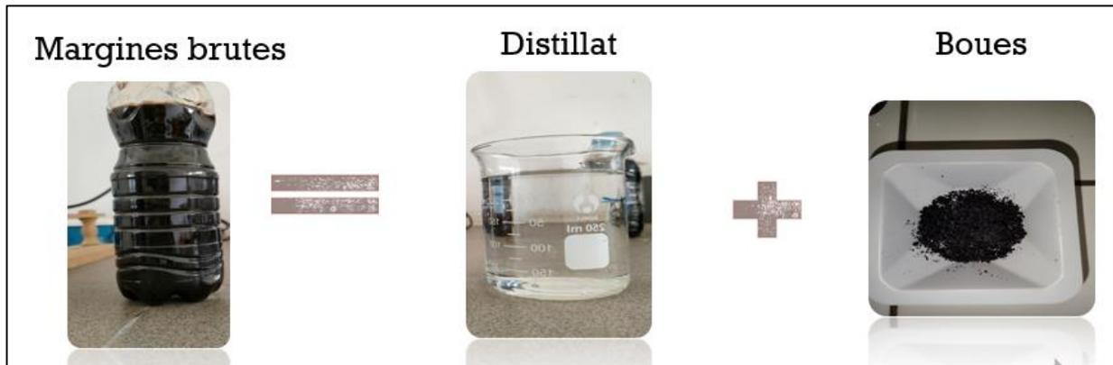
**Figure 3 :** Images des margines avant et après distillation solaire et des boues restantes
